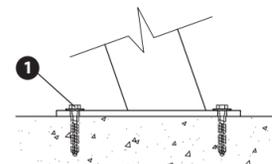
Detalle de fijación standard sobre doble placa multilamina de 18mm (36mm).
