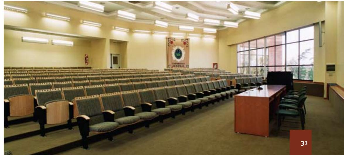
**Modelo Austral:** Butaca desarrollada en madera multilaminada de guatambú con respaldo de simple curvatura, con perforaciones decorativas en la parte superior. El asiento posee una estructura interna metálica. Las patas se ejecutan en tubo de acero, revestidas con un capuchón de fibromadera, que funciona como receptor del apoyabrazos y los protectores frontales y traseros de PVC rígido. Tapizados en tela Chenille City cuadro color Oliva.
